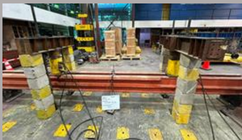
Montaje ensayo de rieles
